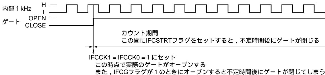
ゲート時間にオープンを選択した場合のゲートの開閉は、IFCCK1, IFCCK0フラグによりゲート時間にオープン以外を設定し直すことにより行います。
