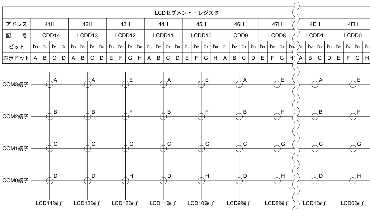
図15 - 4 LCDセグメント・レジスタとLCD表示ドットの関係
