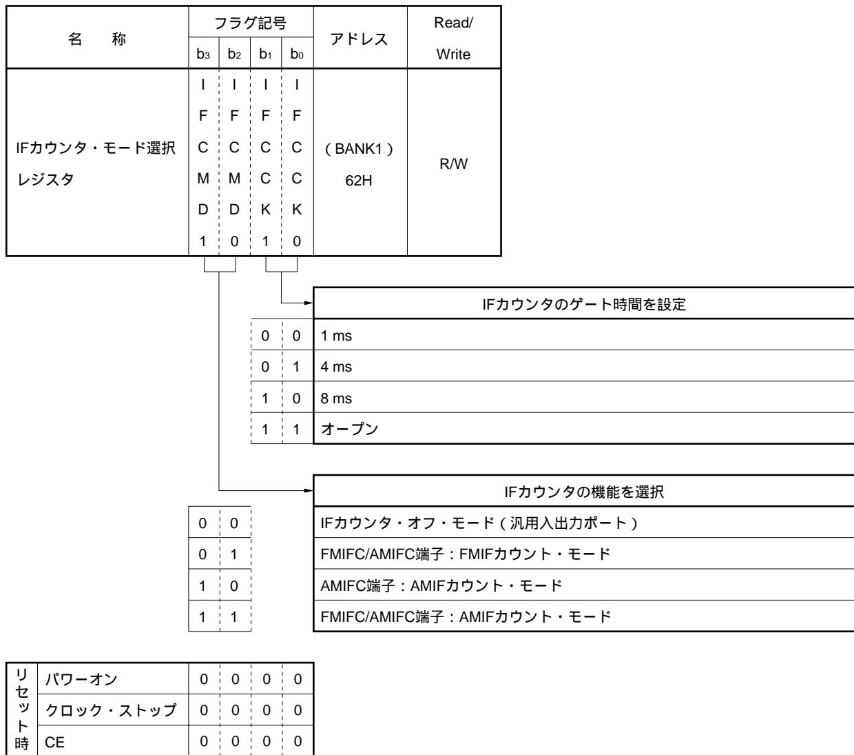
図13 - 3 IFカウンタ・モード選択レジスタの構成
