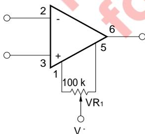
備考 OFFSET NULL端子は，オープンにするか，上図のように抵抗を通じてV<sup>-</sup>に接続して使用してください。V<sup>-</sup>以外への接続は，誤動作，特性劣化，破損の原因となります。
