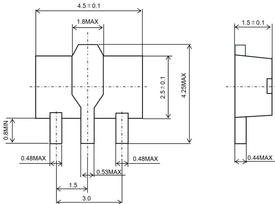
5ピン・プラスチックミニモールド (SC-74A) 外形図
