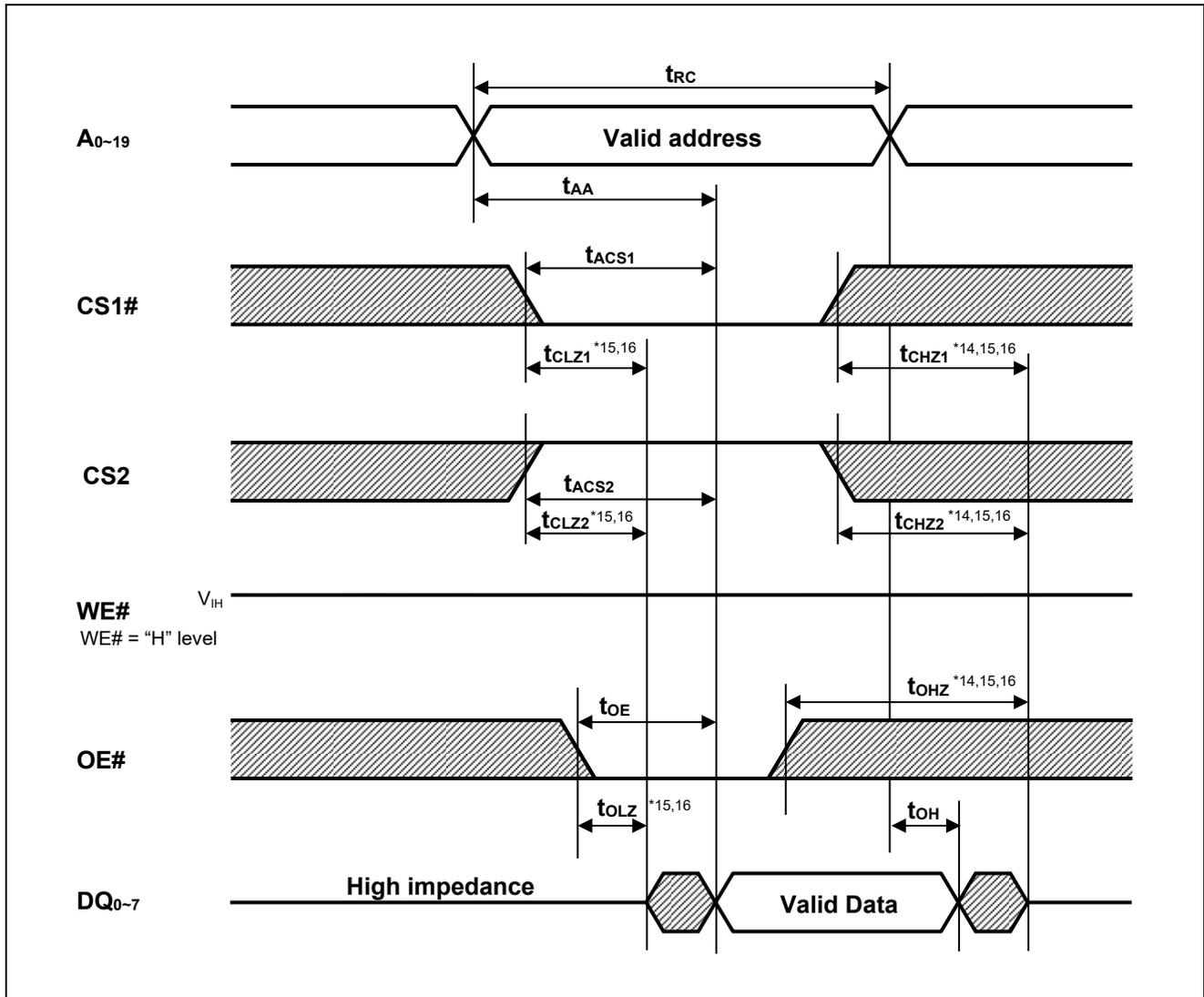
【注】 14.  $t_{CHZ1}$ 、 $t_{CHZ2}$ 、 $t_{OHZ}$  は、DQ 端子がハイ・インピーダンス(High-Z)状態に入る時間として規定され、その時の DQ 端子の電圧レベルには依りません。
