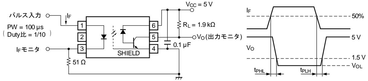
3. 瞬時同相除去電圧測定回路, 波形 ( $CM_H$ ,  $CM_L$ )
