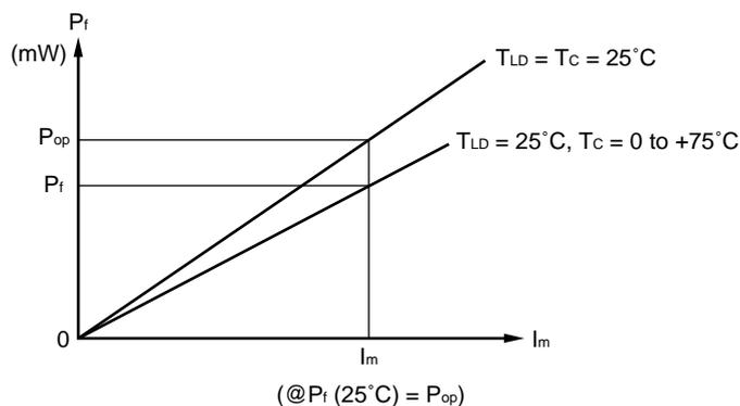
光-電気的特性 ( サーミスタ , TEC に適用 :  $T_{LD} = 25^{\circ}C$  ,  $T_C = 0 \sim +75^{\circ}C$  )
