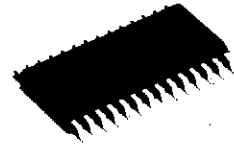
外形 28P2W-A (FP) 1.27mm pitch 450mil SOP (8.4mm×17.5mm×2.0mm)
