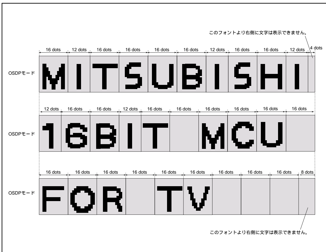
図2.16.38 OSDPモードブロック表示例
