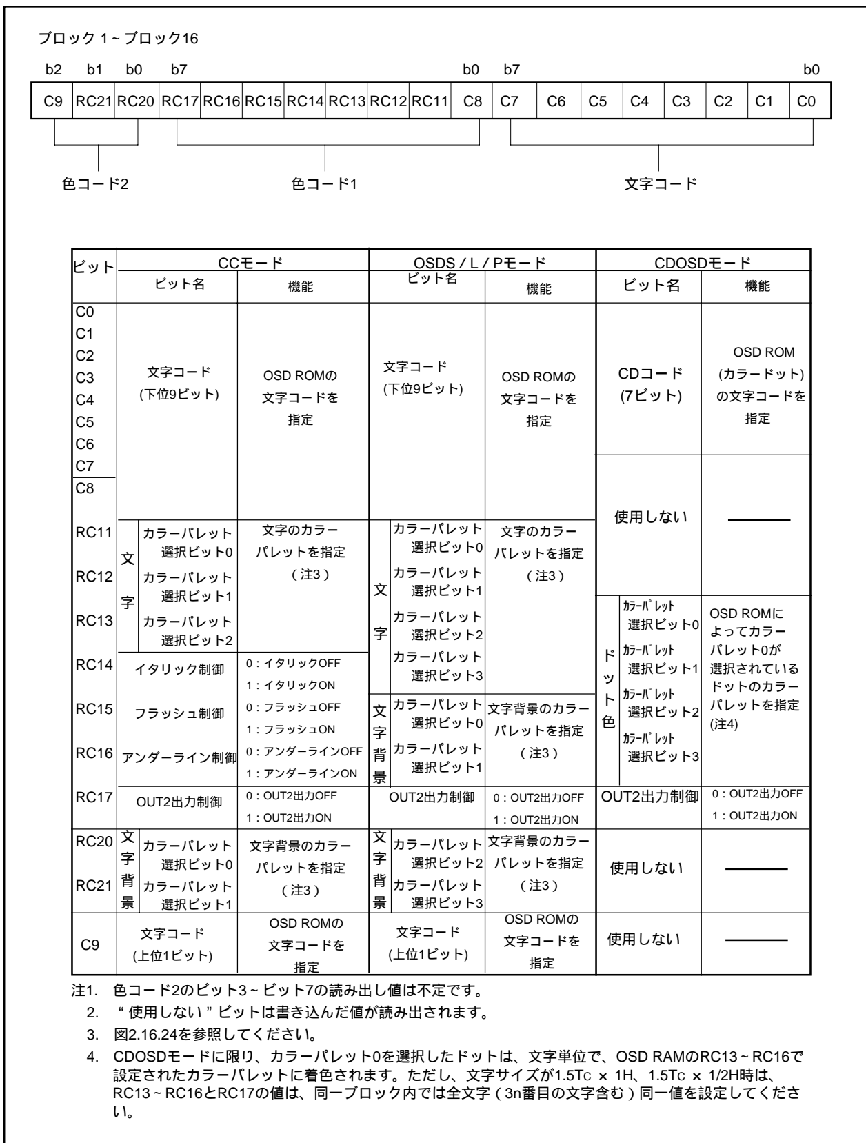
図2.16.24 OSD RAMのビット構成
