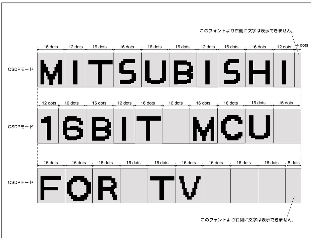
図2.16.39 OSDPモードブロック表示例
