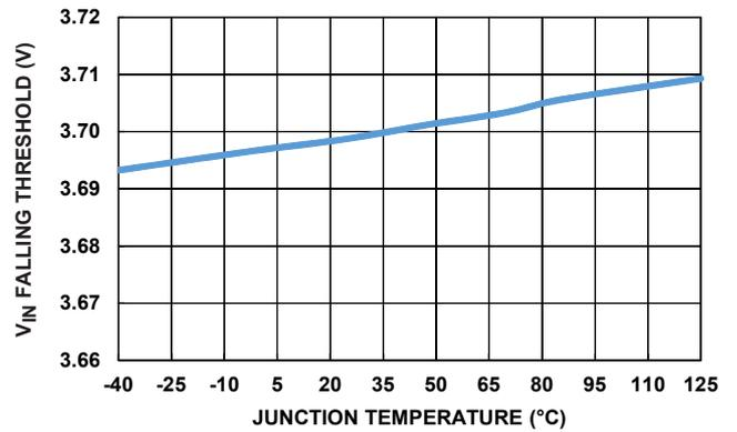
図 23. V<sub>IN</sub> POR (立ち下がり) vs 温度
