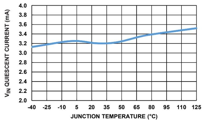
図 19.  $V_{IN}$  静止電流 vs 温度
