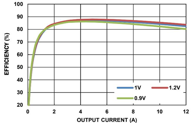
図5. 効率 vs 負荷 ( $V_{IN} = 12V$ 、CCM、300kHz)
