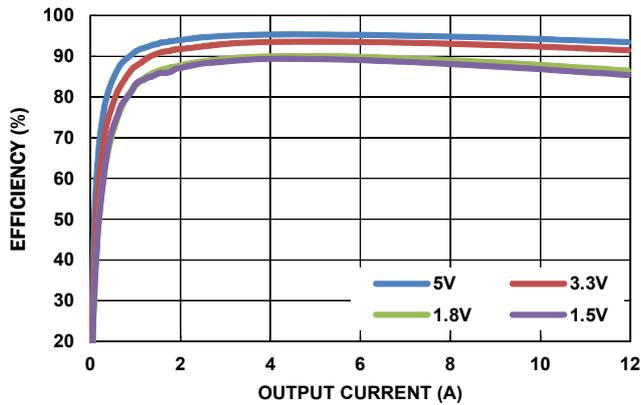
図4. 効率 vs 負荷 ( $V_{IN} = 12V$ 、CCM、600kHz)
