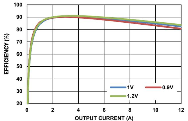
図7. 効率 vs 負荷 ( $V_{IN} = 5V$ 、CCM、300kHz)
