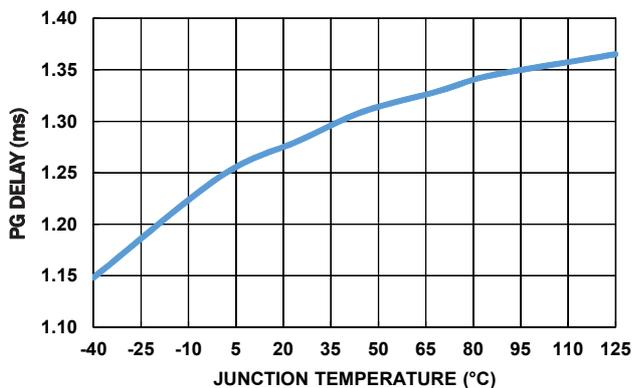
図 26. PG デレイ vs 温度
