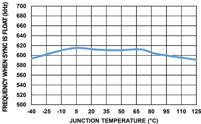
図 24. 周波数 (600kHz 設定) vs 温度
