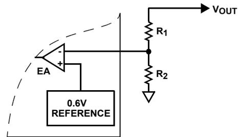
図 31. 外付けの抵抗分圧回路
