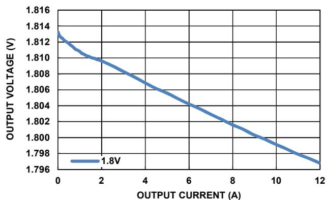
図8.  $V_{OUT}$  のレギュレーション vs 負荷 ( $V_{IN} = 12V$ 、CCM、600kHz)
