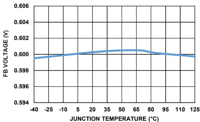
図 20. 帰還電圧 vs 温度
