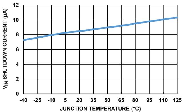
図 18.  $V_{IN}$  シャットダウン電流 vs 温度
