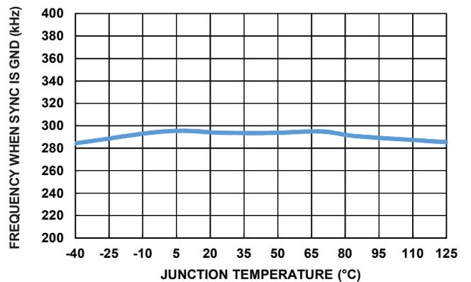
図 25. 周波数 (300kHz 設定) vs 温度
