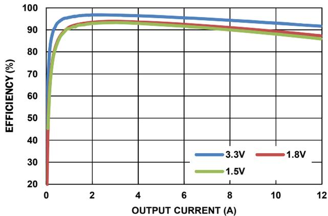
図6. 効率 vs 負荷 ( $V_{IN} = 5V$ 、CCM、600kHz)
