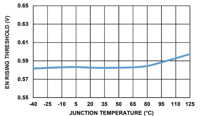
図 21. イネーブル・スレッショルド vs 温度
