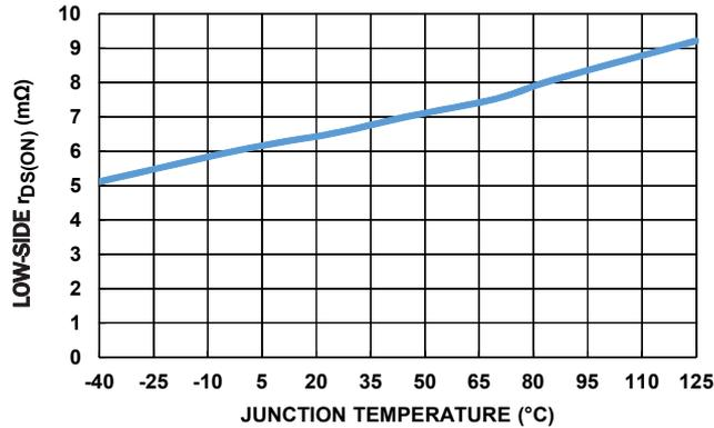
図 28. ローサイド  $r_{DS(ON)}$  vs 温度
