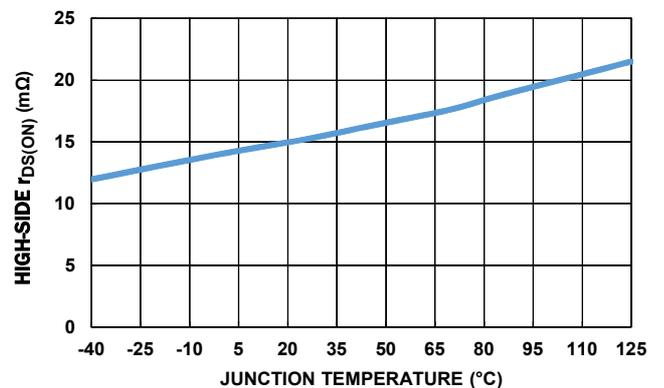
図 27. ハイサイド r<sub>DS(ON)</sub> vs 温度
