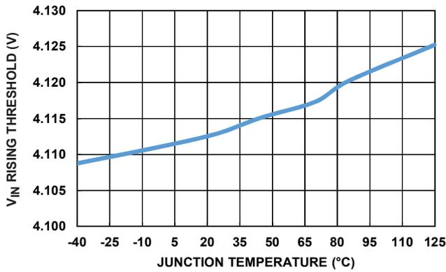
図 22. V<sub>IN</sub> POR (立ち上がり) vs 温度
