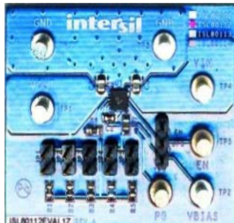
図 39. ISL80113EVAL1Z (左 : PCB 上面、右 : 写真)
