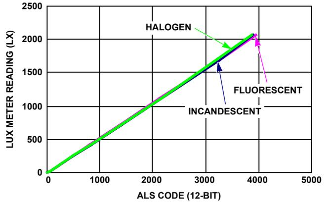
FIGURE 9. ALS LINEARITY OVER 3 LIGHT SOURCES (2000 LUX RANGE)
