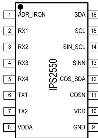
図 1 16-TSSOP パッケージのピン配置-上面図
