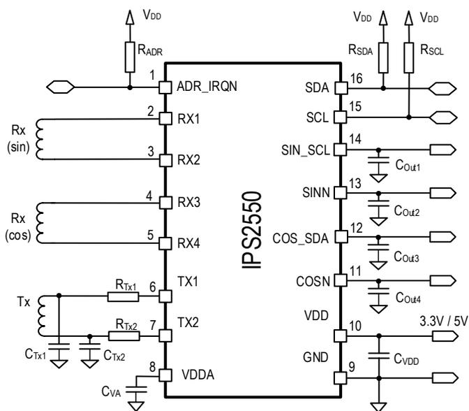
分割コンデンサ  $C_{Tx1} = C_{Tx2}$ 、Tx コイル直列抵抗  $R_{Tx1} = R_{Tx2}$  および出力コンデンサを使用した IPS2200 互換モードでの構成
