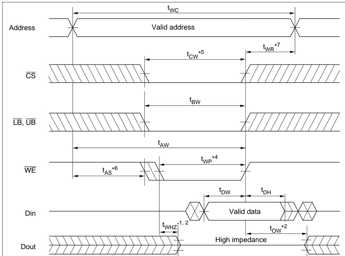
ライトサイクル(2) ( $\overline{CS}$  Clock,  $\overline{OE} = V_{IH}$ )
