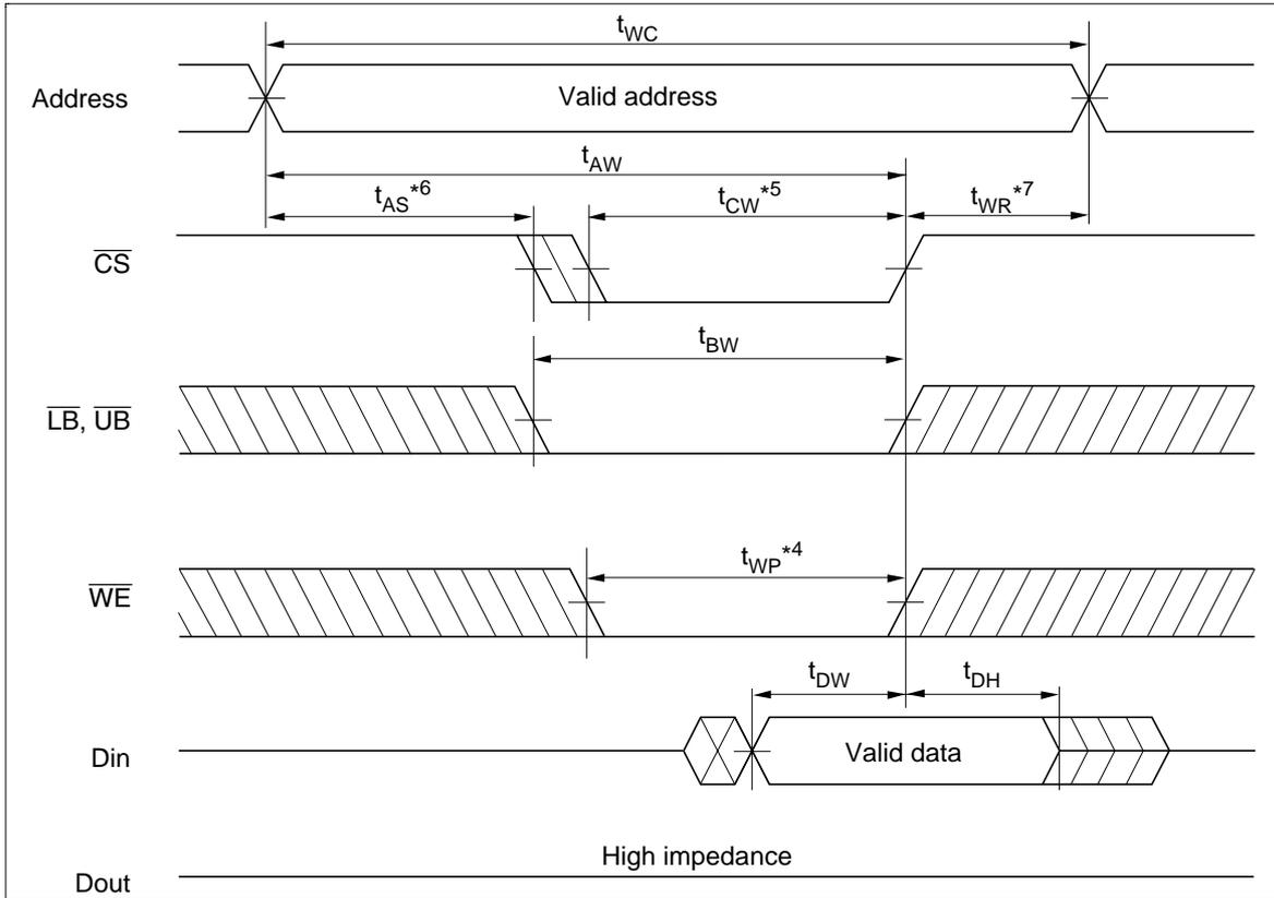
ライトサイクル(3) ( $\overline{\text{LB}}$ ,  $\overline{\text{UB}}$  Clock,  $\overline{\text{OE}} = V_{\text{IH}}$ )
