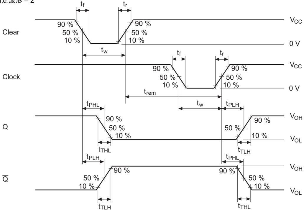
【注】 1. 入力波形 :  $PRR \leq 1 \text{ MHz}$ ,  $Z_o = 50 \Omega$ ,  $t_r \leq 6 \text{ ns}$ ,  $t_f \leq 6 \text{ ns}$
