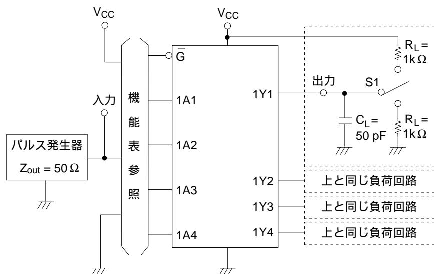
【注】 1. C<sub>L</sub>はプローブ、治具等の浮遊容量を含みます。
