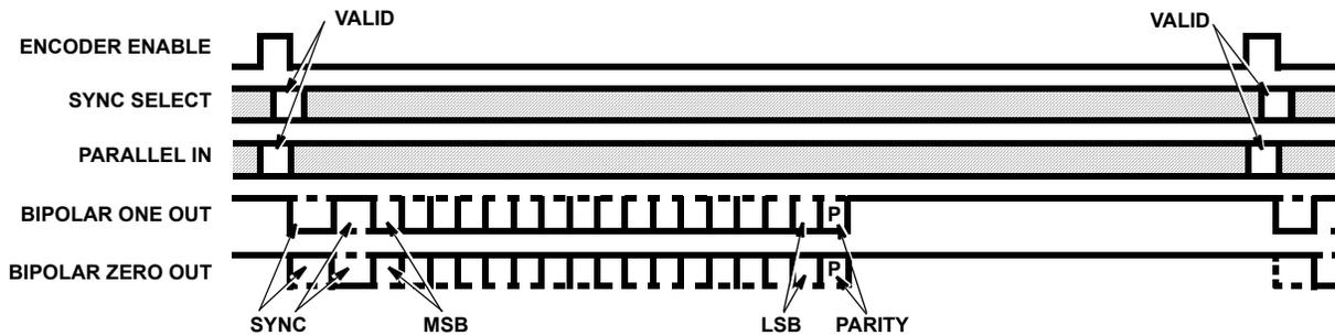
FIGURE 4. ENCODER TIMING
