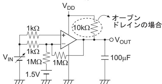
【注】  $V_{IO} = V_{OUT} - 1.5V$
