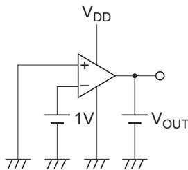
6. 出力電圧ロー,  $V_{OL}$
