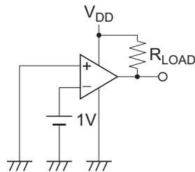
7. 入力オフセット電圧,  $V_{IO}$
