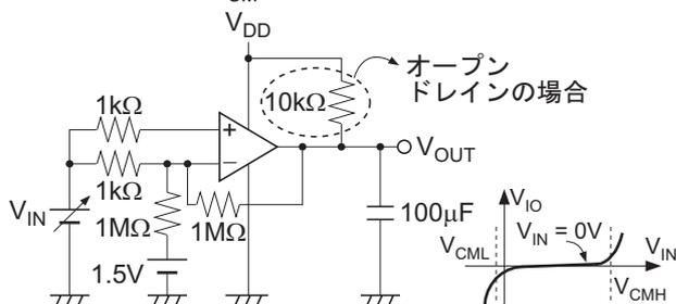
【注】  $V_{IN} = 0V$  の  $V_{IO}$  を基準に  $V_{IO}$  が 50dB 変化したときの  $V_{IN}$  の低い側を  $V_{CML}$ , 高い側を  $V_{CMH}$  とした。
