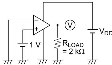
3. 出力ロー電圧,  $V_{OL}$
