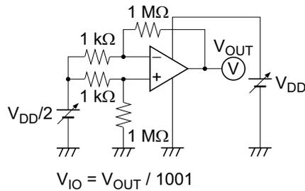
7. 入力オフセット電圧,  $V_{IO}$
