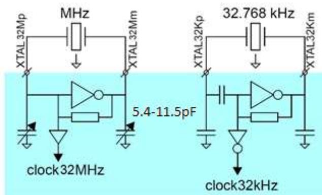
[Figure 37. Crystal oscillator circuits](#)
