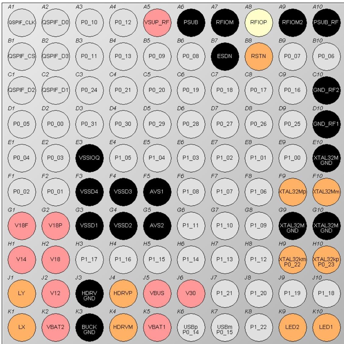
□ Digital    ■ Analog    □ Radio    ■ Power    ■ GND
