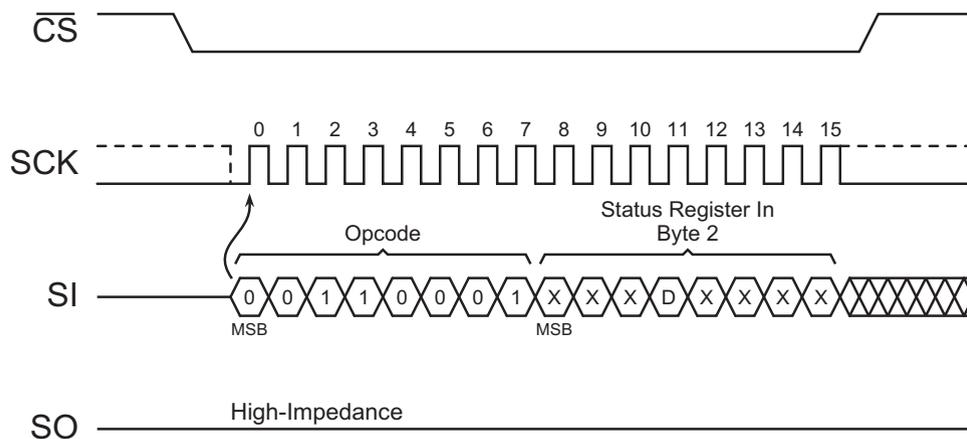
Figure 29. Write Status Register Byte 2
