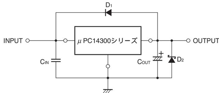
C<sub>IN</sub> : 0.1 ~ 0.47 μF。電源平滑回路と INPUT 端子とのラインに応じて選定してください。使用するコンデンサには、フィルム・コンデンサのような電圧特性、温度特性に優れたものを推奨します。積層セラミック・コンデンサには温度特性や電圧特性が悪いものがありますので注意してください。積層セラミック・コンデンサを使用する場合は、使用する電圧、温度範囲でこの容量値が確保できる必要があります。
