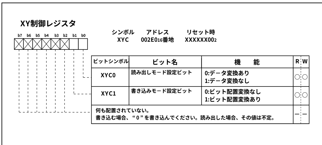
図1.24.1. XY制御レジスタの構成
