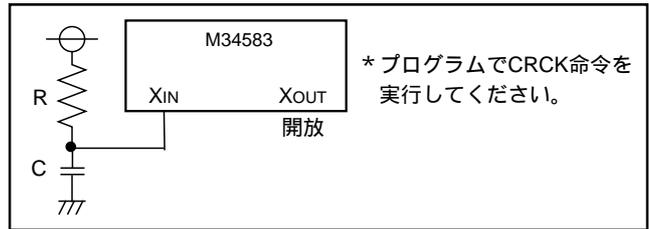
図WA-5 . RC発振外付け回路
