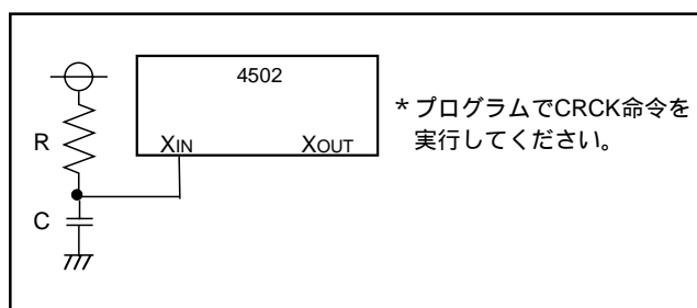
図WA-5 . RC発振外付け回路
