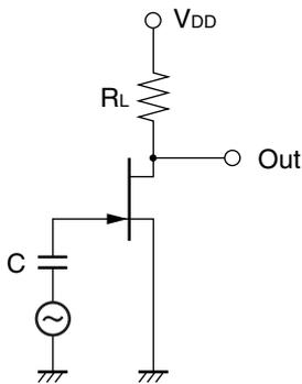
雑音電圧測定回路
