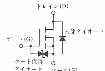
本製品のゲート・ソース間に内蔵されている保護ダイオードは取り扱い上における静電破壊の保護のためであり、実使用回路ではゲート・ソース間に外付け定電圧ダイオード等のゲート保護回路を入れて使用していただきますようお願いいたします。
