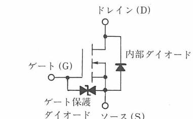
本製品のゲート・ソース間に内蔵されている保護ダイオードは取り扱い上における静電破壊の保護のためであり、実使用回路ではゲート・ソース間に外付け定電圧ダイオード等のゲート保護回路を入れて使用していただきますようお願いいたします。
