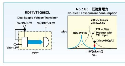
TTL製品を低電圧から高電圧への レベル変換に使用した場合、入力部に余分な 消費電流が流れる。(Icc) 2電源方式にすることで、この電流を ほぼゼロアンペアにできます。
