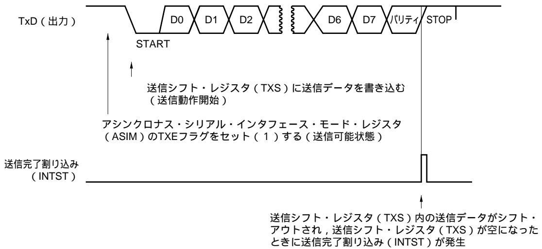
図3 - 4 送信時の動作タイミング(ストップ・ビット長=1)
