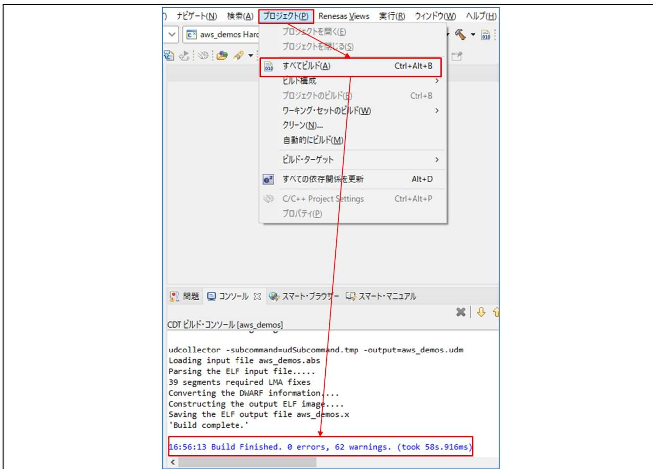
図 2-2 プロジェクト -> すべてビルド -> 0 errors
