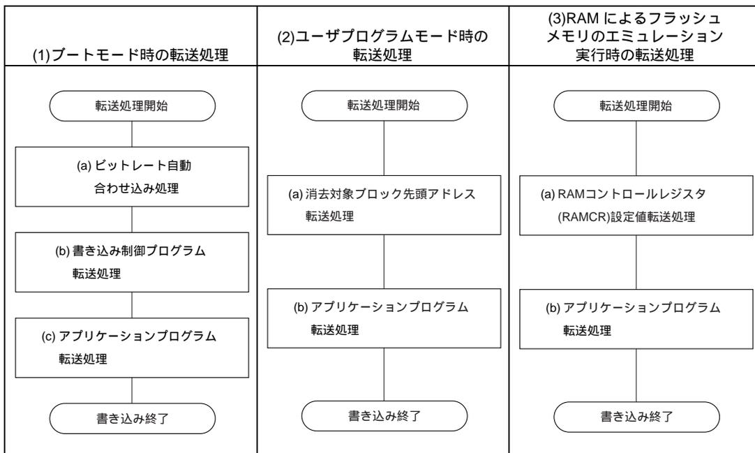
図 2.18 PC I/F ソフト各モード時の転送処理
