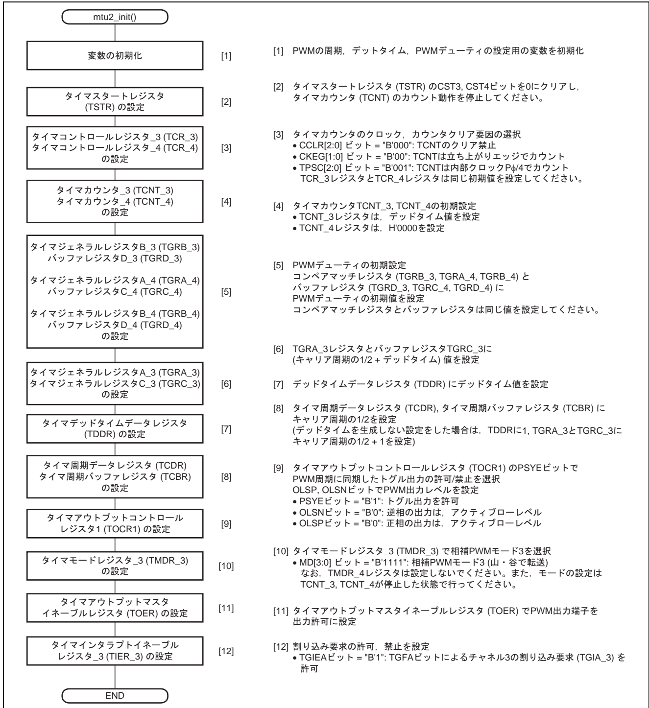
図 13 マルチファンクションタイマパルスユニット 2 (MTU2) の初期設定
