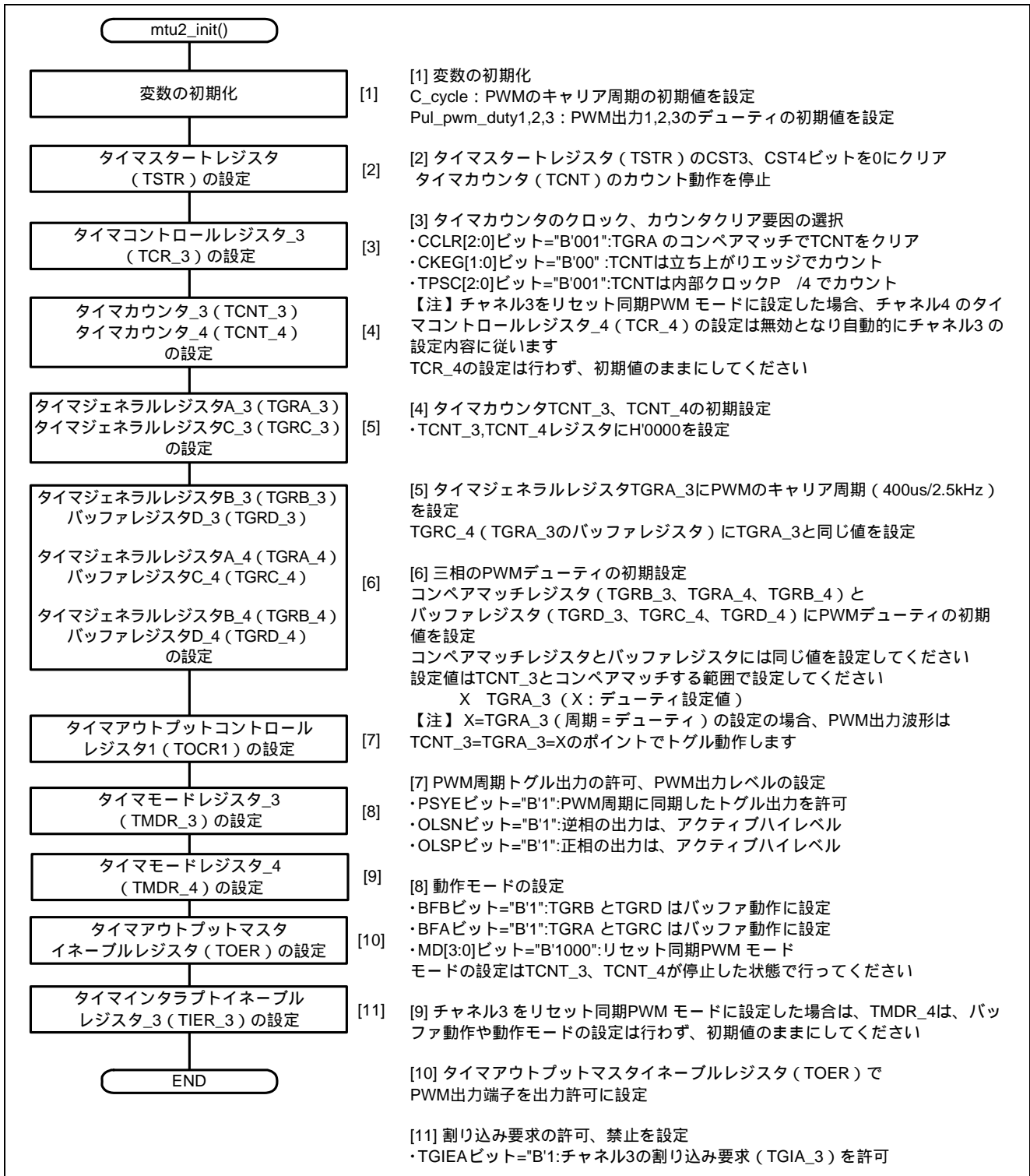
図8 マルチファンクションタイマパルスユニット 2 (MTU2) の初期設定
