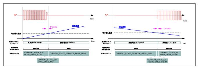
図 7-13 加速時および減速時のセンサレスアルゴリズム切替
