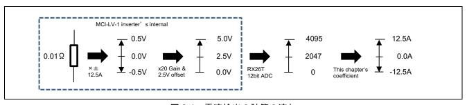
図 9-1 電流検出の計算の流れ
