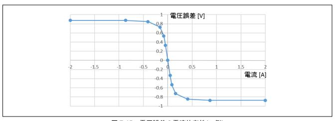
図 7-15 電圧誤差の電流依存性(一例)
