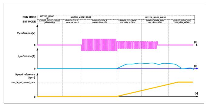
図 8-5 全速度域センサレスベクトル制御の始動制御内容
