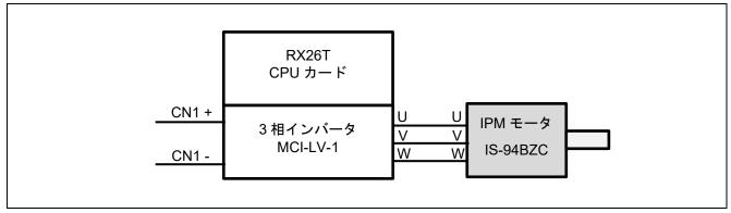
図 4-6 インバータ~モータ間の配線
