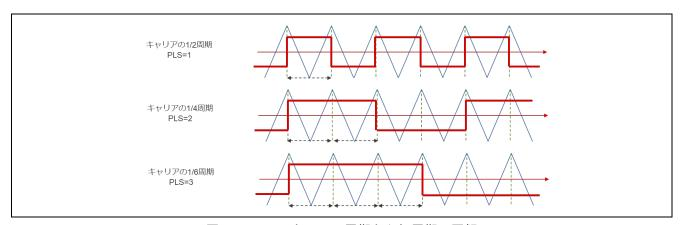
図 9-4 PWM キャリア周期と印加周期の図解
