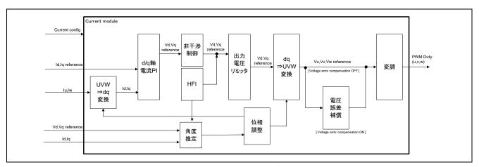
図 7-4 電流制御の機能ブロック図
