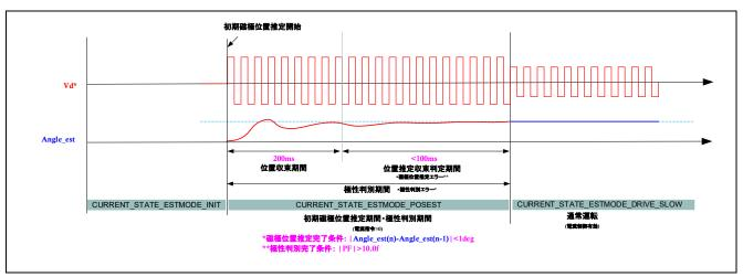
図 7-12 始動時の磁極位置推定動作
