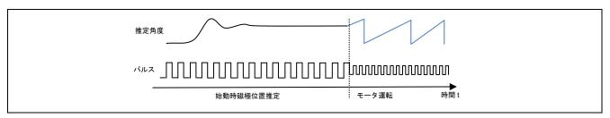
図 7-10 推定角度と高周波パルス印加の例
