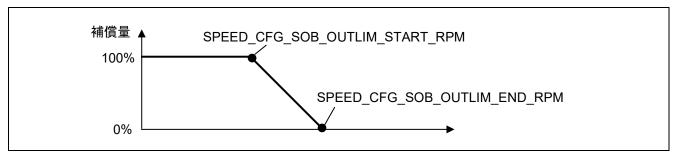
図 9-3 外乱トルク・速度推定オブザーバの補償量とパラメータの関係
