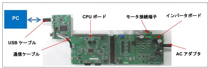
図 4-3 キット (MCK-RX26T) の接続例
