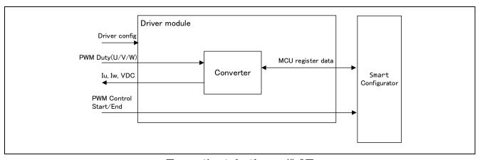
図 8-6 ドライバモジュール構成図
