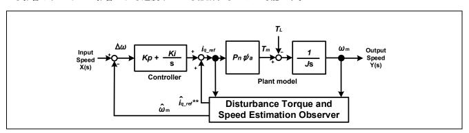
図 7-3 外乱トルク・速度推定オブザーバのブロック図
