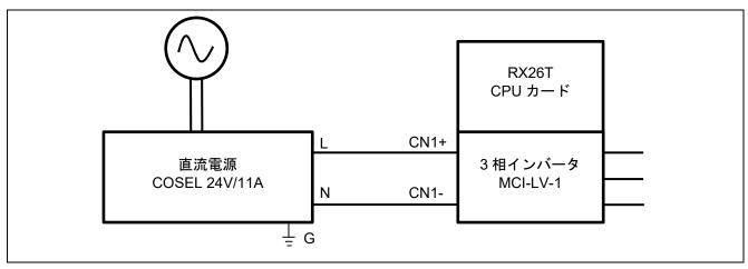
図 4-5 電源~インバータ間の配線
