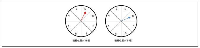
図 7-11 8極 IPM モータにおける磁極位置とN極・S極
