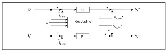
図 7-5 非干渉制御の機能ブロック図
