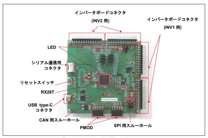
図 4-2 RX26T CPU カードとインタフェース
