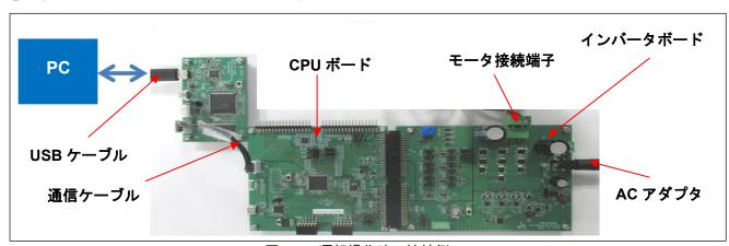
図 6-2 運転操作時の接続例
