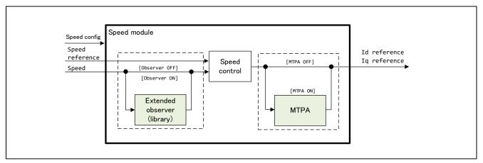
図 7-2 速度制御の機能ブロック図
