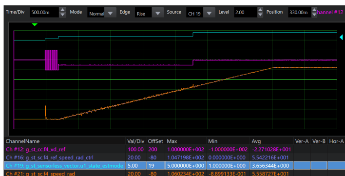
図 12-3 センサレス制御時の始動特性波形
