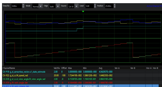
図 12-4 パルス電圧印加 (HFI) と BEMF オブザーバによるセンサレスベクトル制御の切り替え波形
