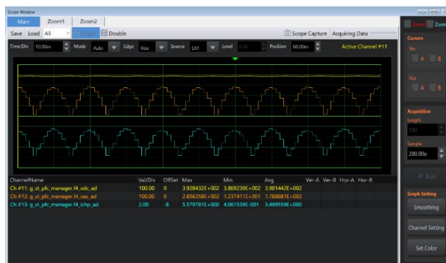
図 12-1 PFC 制御の 390V 昇圧状態波形例
