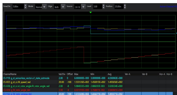
図 12-4 パルス電圧印加 (HFI) と BEMF オブザーバによるセンサレスベクトル制御の切り替え波形
