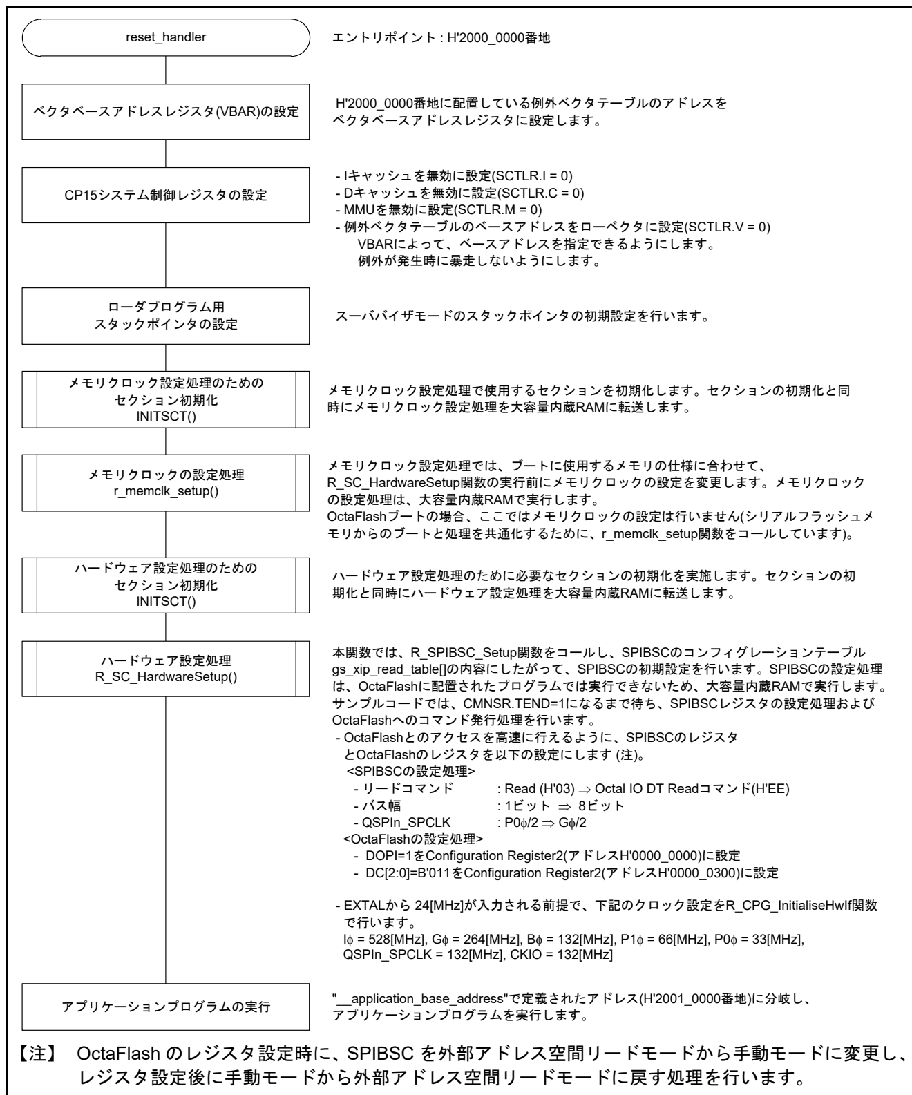
図5.4 ロードプログラム（全体）のフローチャート
