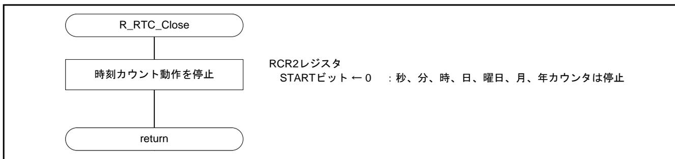
図6.27 RTCの時刻カウント動作停止関数
