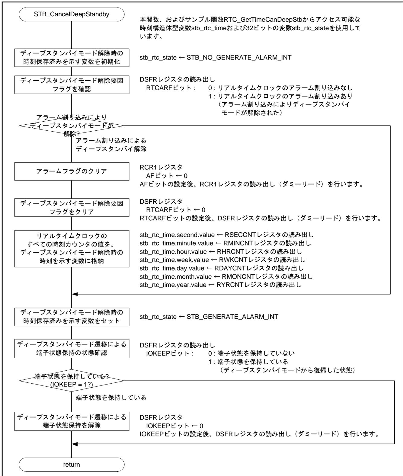
図6.11 ディープスタンバイモードの解除要因に応じた処理
