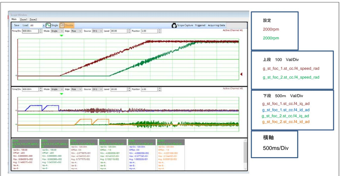
図 5-2 起動時駆動波形 (2/3) (モータ 1、モータ 2)
