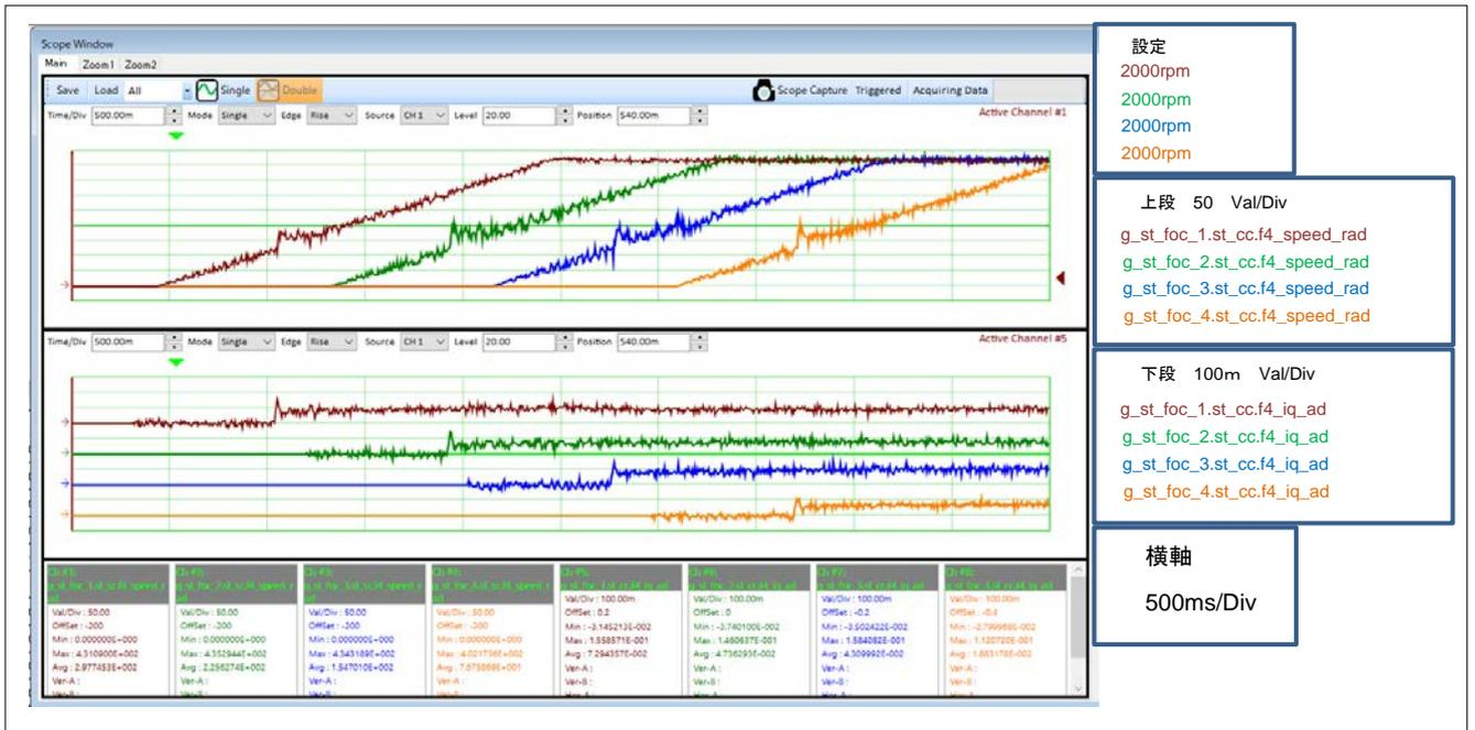
図 5-1 起動時駆動波形（1/3）（モータ 1、モータ 2、モータ 3、モータ 4）
