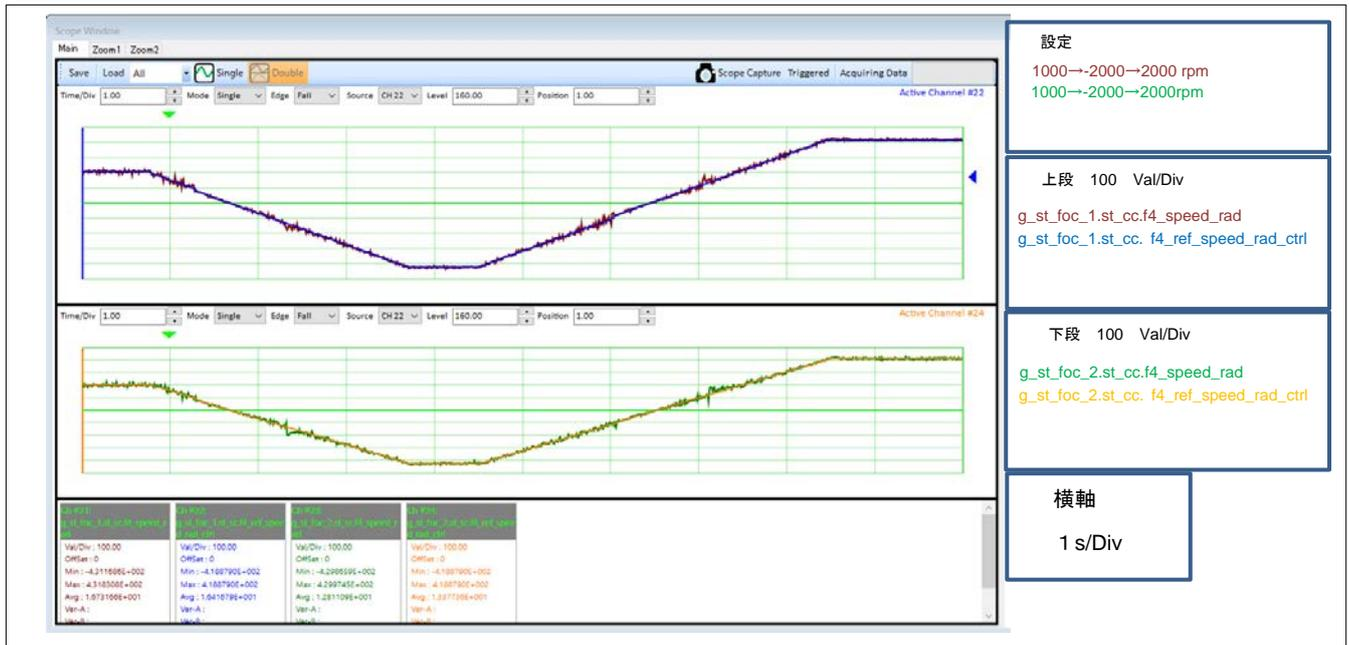
図 5-5 過渡時駆動波形（1/2）（モータ 1、モータ 2）
