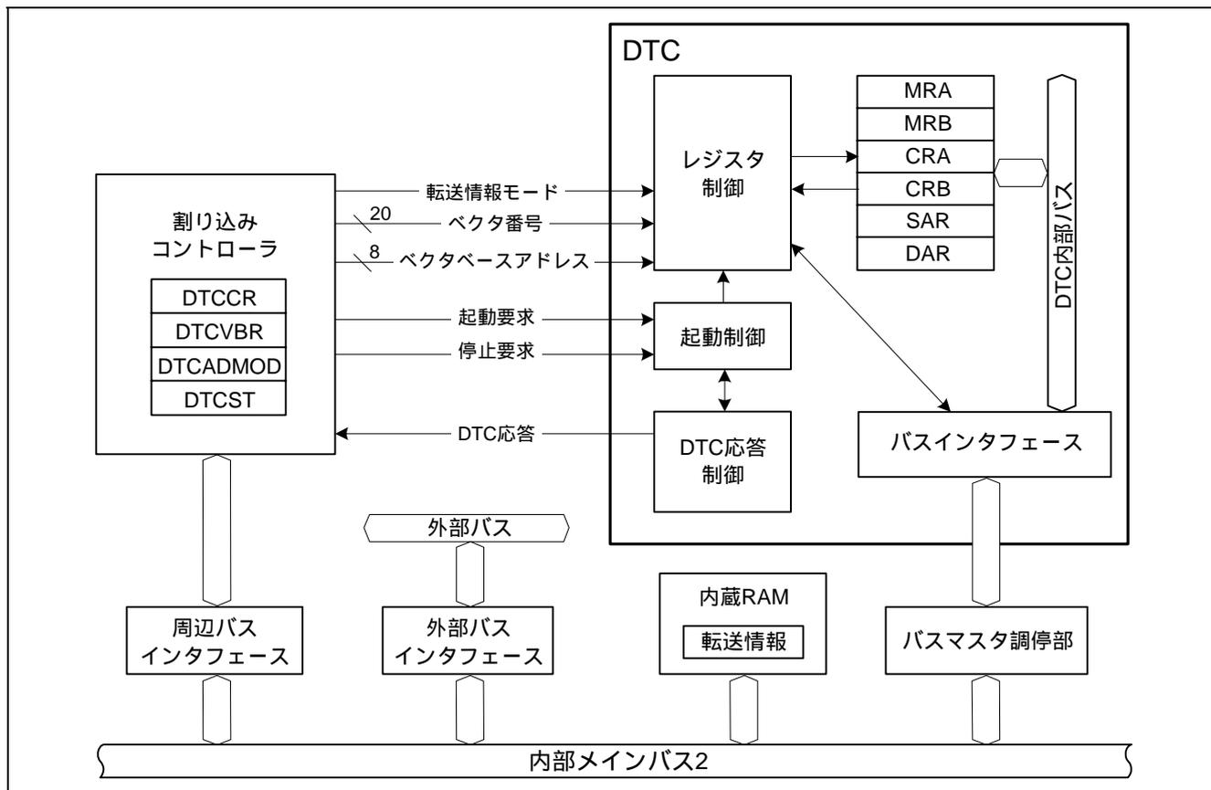
図 4 DTC ブロック図
