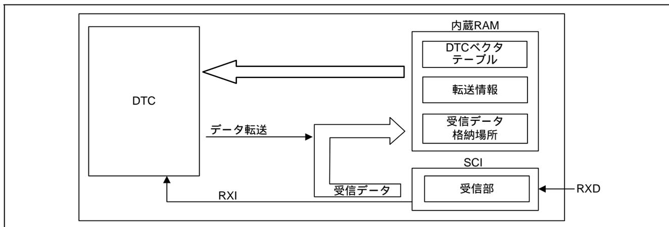
図 1 DTC を用いた調歩同期式シリアルデータ受信の概要
