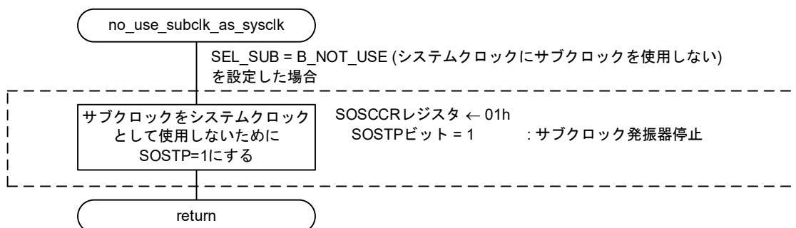
図 4.13 サブクロックをシステムクロックとして使用しない場合の設定
