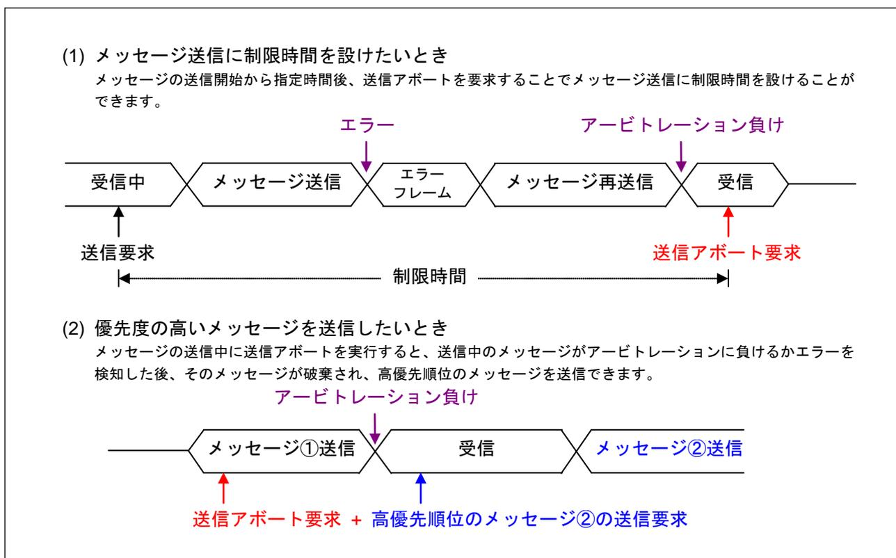
図 11. 送信アボート機能の応用例
