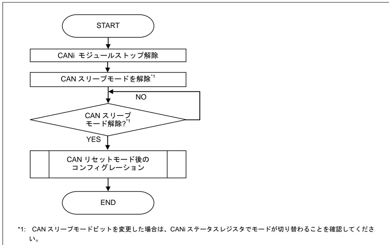
図 44. CAN リセットモード時の CAN スリープ解除手順
