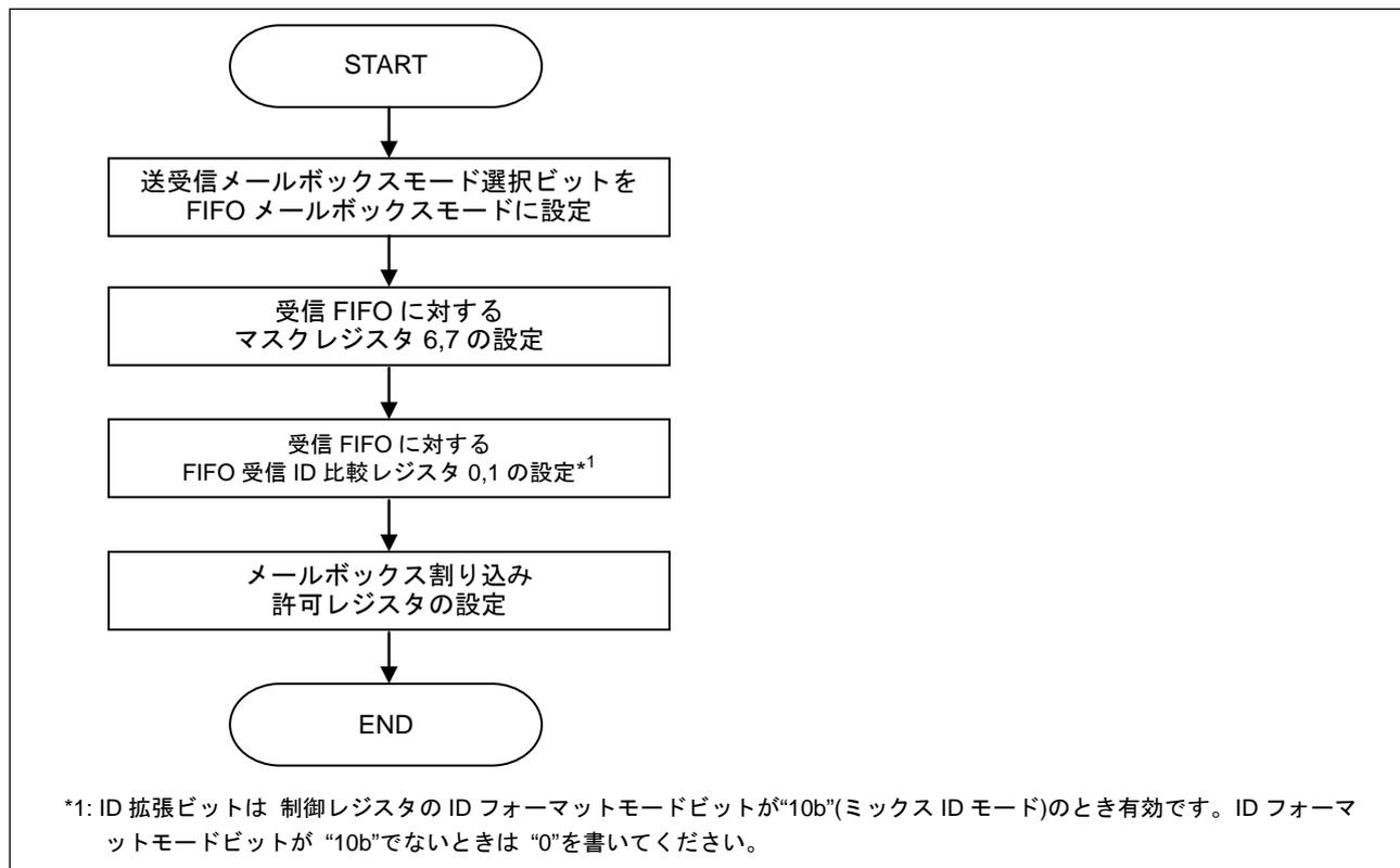
図 21. CAN コンフィグレーションの FIFO メールボックスモード設定手順
