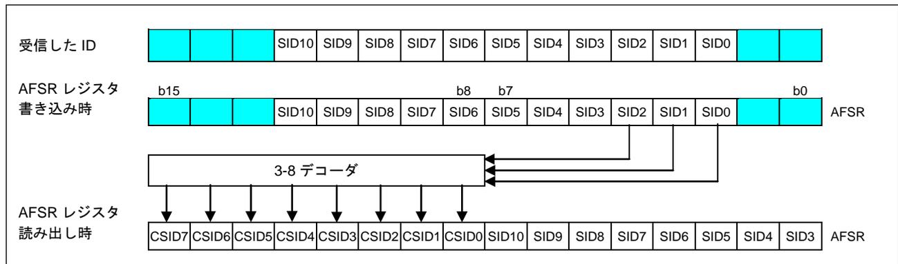
図 40. アクセプタンスフィルタサポートレジスタへの書き込み、読み出し時の状態
