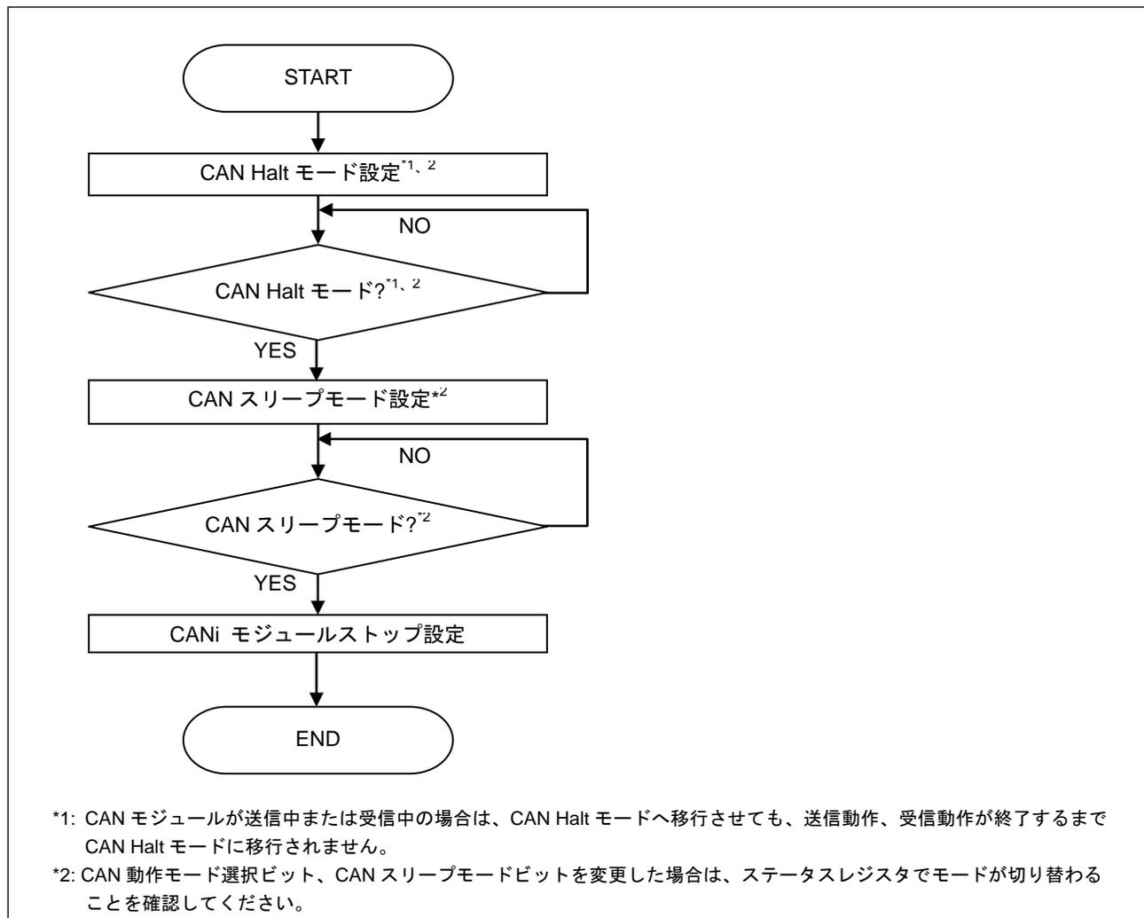
図 43. CAN モジュールを CAN Halt モードへ移行してから CAN スリープモードへ移行させる手順
