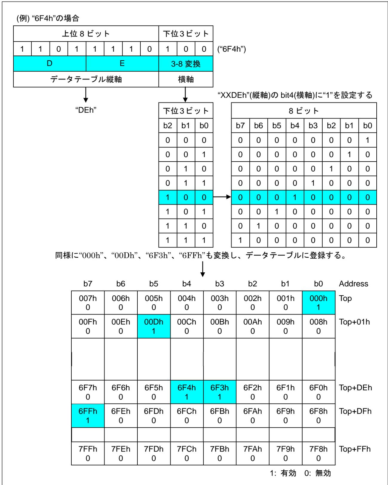
図 39. データテーブル構成(データテーブル作成例)
