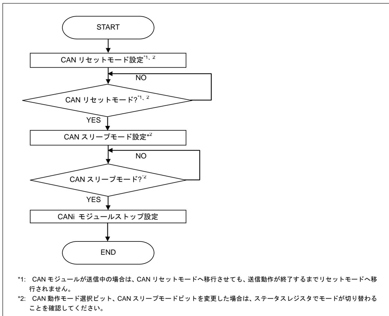
図 42. CAN モジュールを CAN リセットモードへ移行してから CAN スリープモードへ移行させる手順
