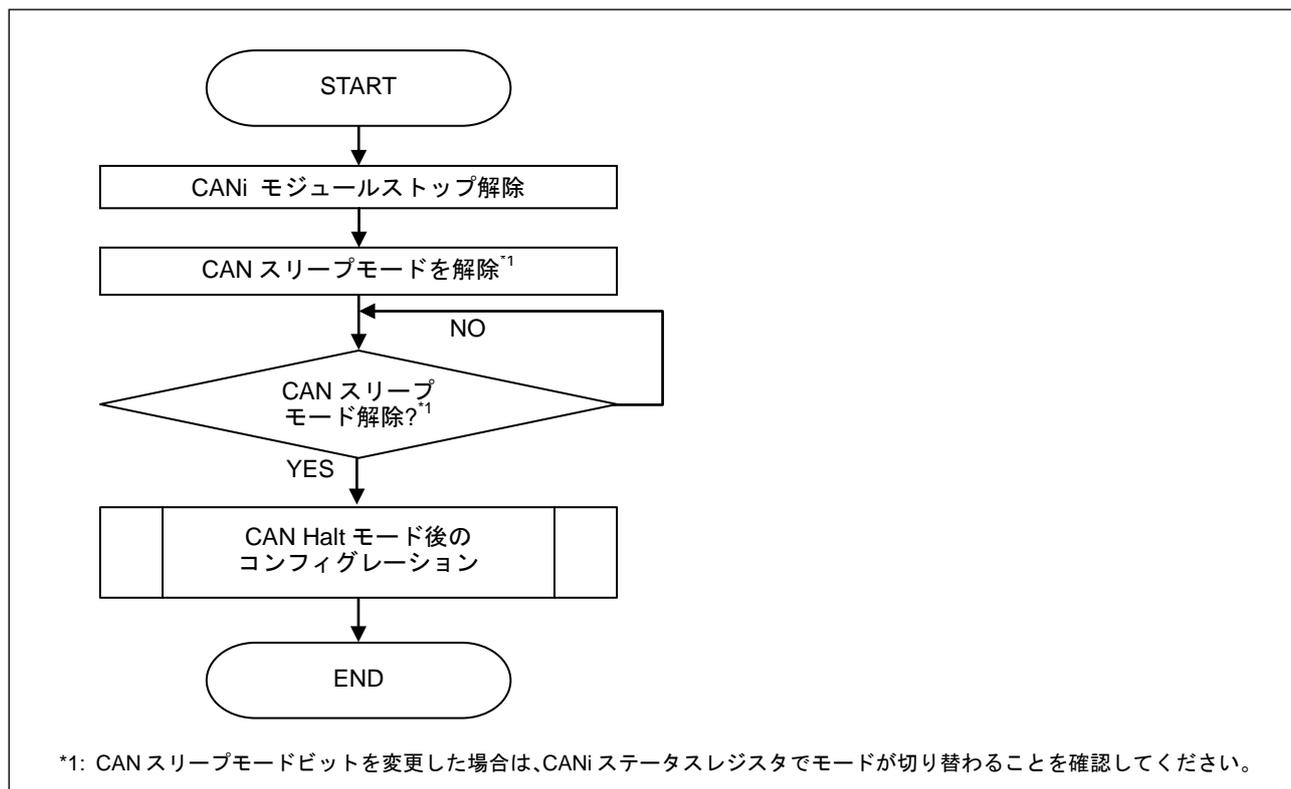
図 45. CAN Halt モード時の CAN スリープ解除手順
