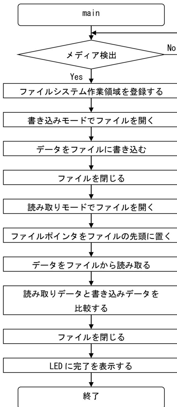
図 2.1 サンプルプログラムの処理フロー
