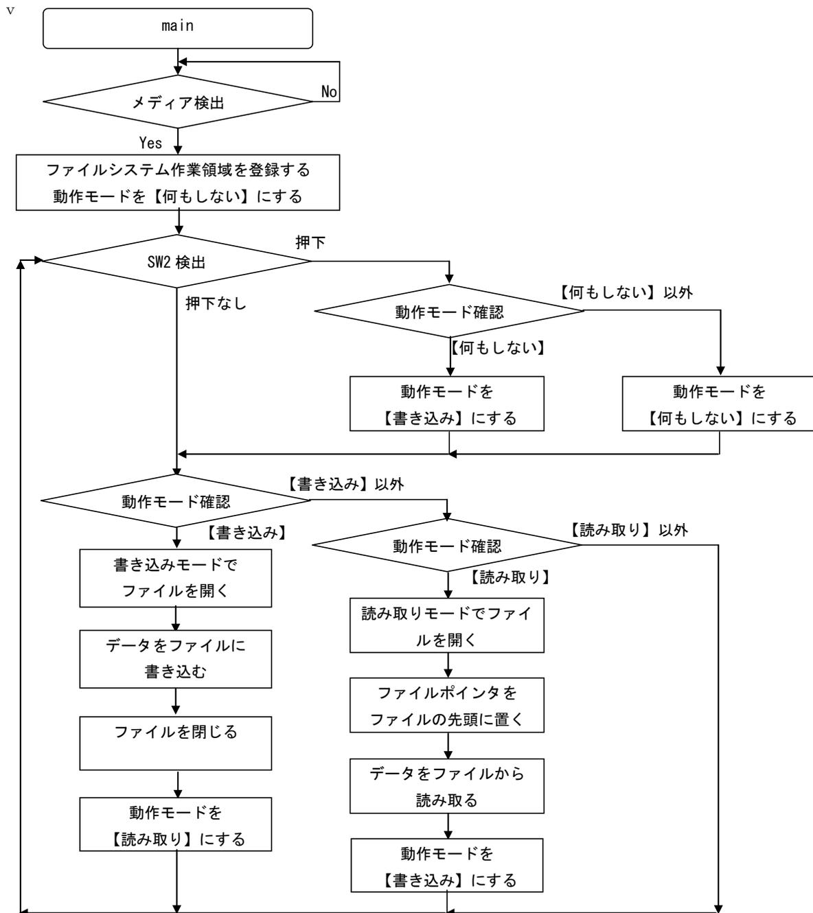
図 2.2 サンプルプログラムの処理フロー
