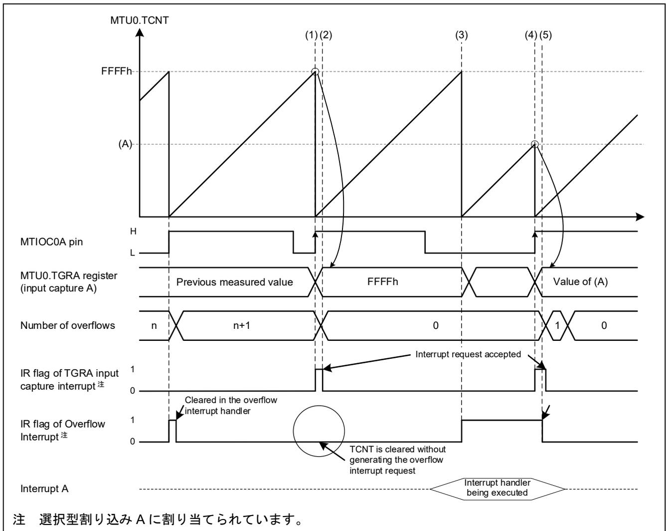
図 3-15 インพุットキャプチャとオーバーフローが同時に発生したときの動作
