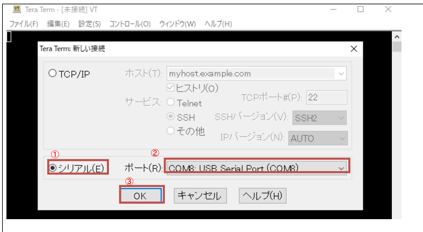
図 1-4 TeraTermの起動、ポートの設定
