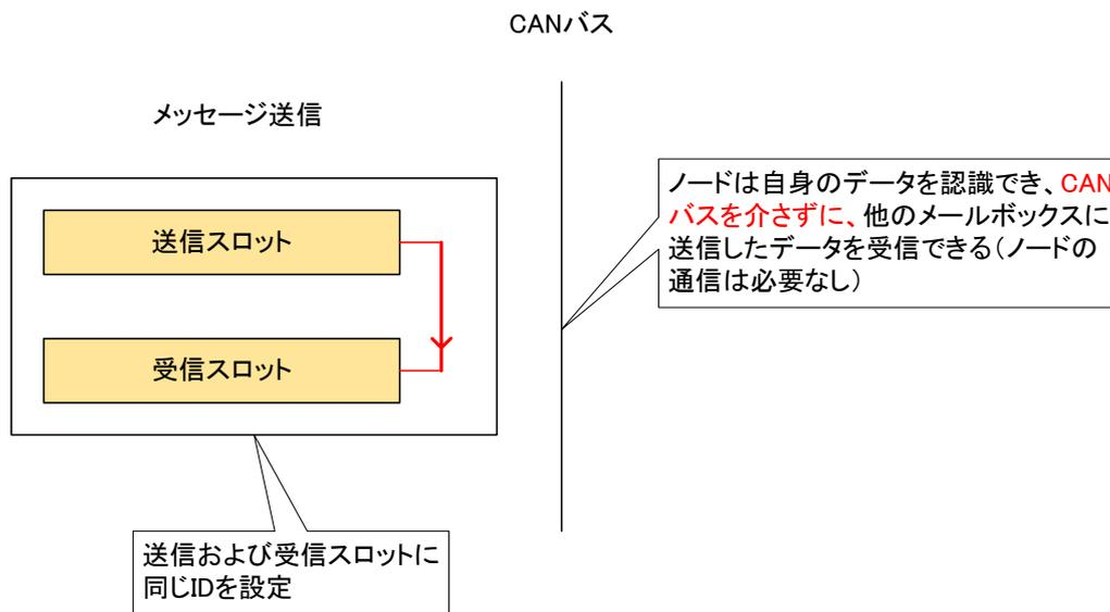
CAN 内部ループバックモードでは、CAN バスを接続しない状態でノードの機能をテストできます。
