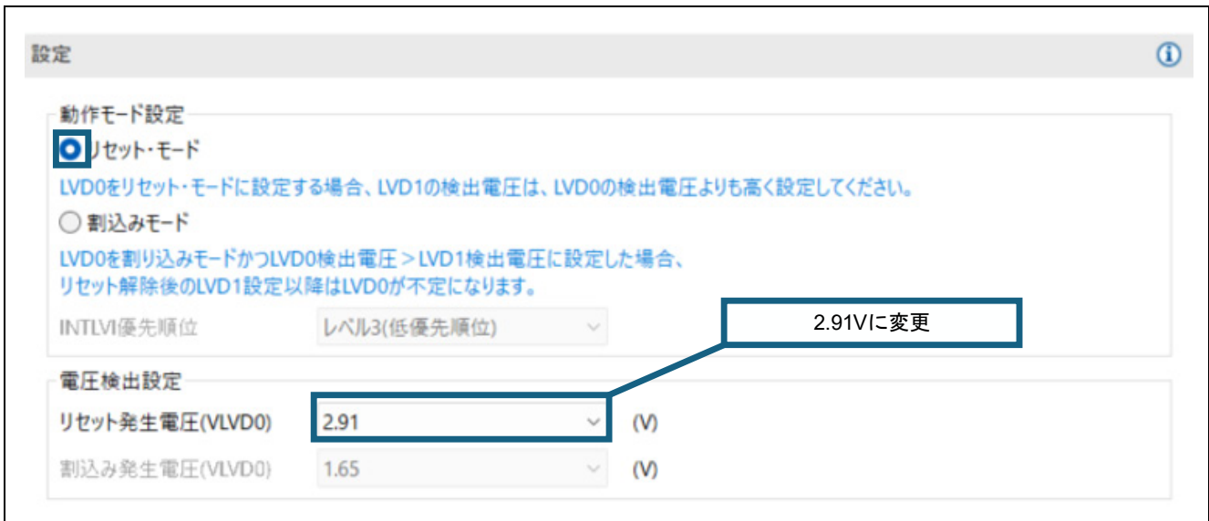
図 5-4 LVD コンポーネント（Config_LVD0）の設定
