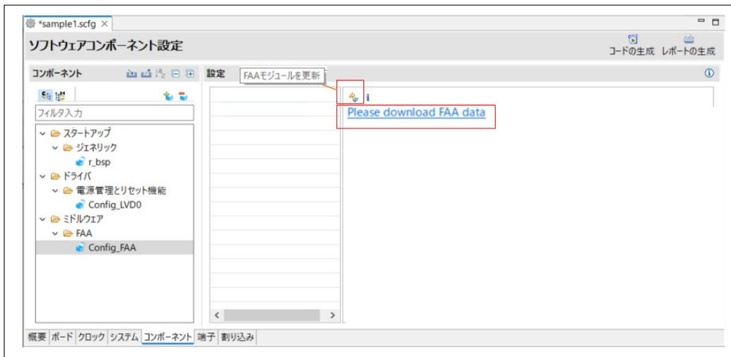
12. ダウンロードするライブラリを選択し、「ダウンロード」をクリックします。続いて表示される「免責事項」ダイアログで、「Accept」をクリックします。
