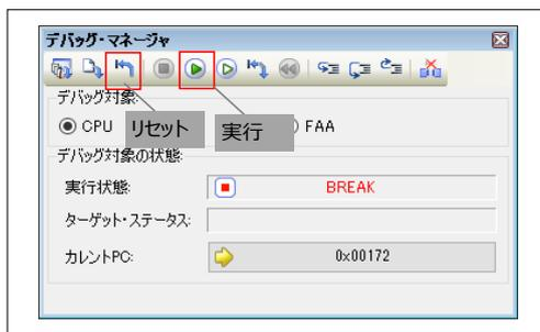
7. ブレークポイントで停止後、デバッグ・マネージャでデバッグ対象を FAA へ変更します。
