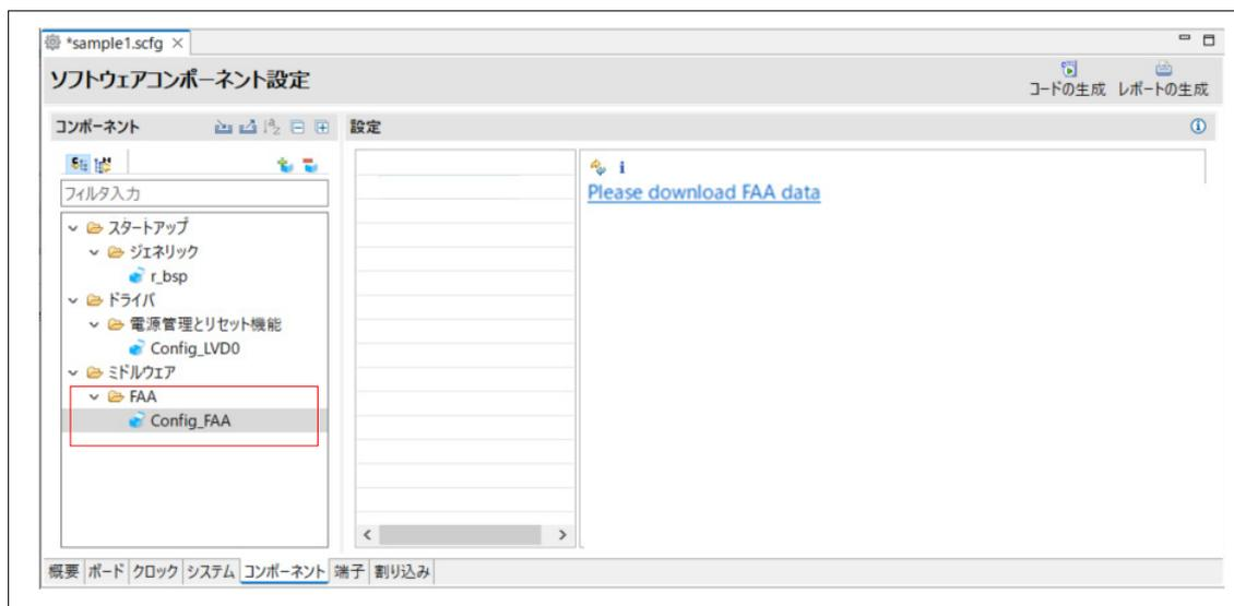
11. FAA コンポーネントを初めて使用する場合、FAA ライブラリまたはテンプレートをスマート・コンフィギュレータ専用のサーバからダウンロードする必要があります。ダウンロードするために「FAA モジュールを更新」または「Please download FAA data」をクリックします。（「FAA モジュールを更新」は、新規 FAA ライブラリや最新バージョンの確認・取得時にも利用してください。）
