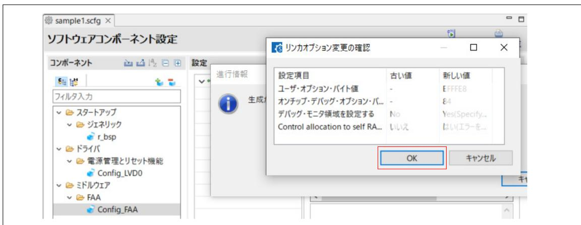
備考. スマート・コンフィグレータ (SC) の「クロック」、「システム」、「電圧検出回路」(LVD0) で設定した一部項目の内容は、ビルド・ツール (CC-RL) のリンクオプションの設定に反映されま
