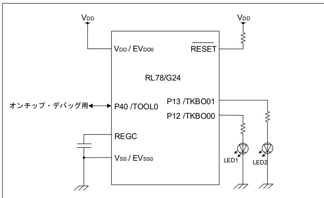
注意 1. この回路イメージは接続の概要を示す為に簡略化しています。実際に回路を作成される場合は、端子処理などを適切に行い、電気的特性を満たすように設計してください（入力専用ポートは個別に抵抗を介して VDD 又は VSS に接続してください）。
