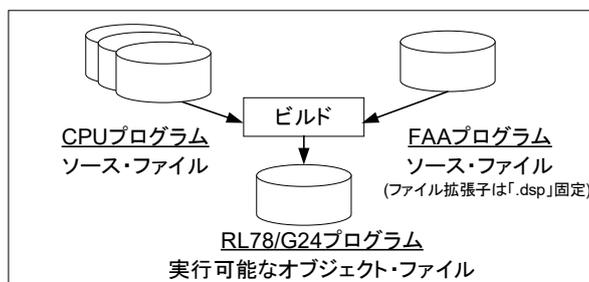
図 1-4 RL78 用スマート・コンフィグレータ (SC) で提供する FAA 関連のファイル
