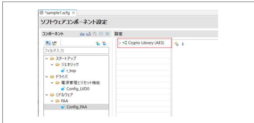
14. ダウンロードしたライブラリのうち、実際に使用するライブラリ/機能をチェックします。チェックした機能のプロパティで、設定項目がある場合は適宜設定します。
