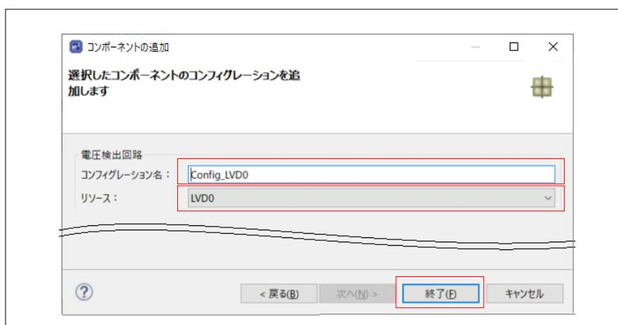
7. 使用するコンポーネントのツリーに電圧検出回路が追加されます。設定画面で、システムに合わせて電圧検出回路を設定します。
