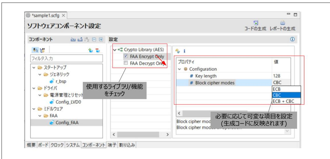
備考：ライブラリ/機能は、他と組み合わせて使用可能なタイプ（サブプロセッサ型）と組み合わせ使用不可のタイプ（独立型）があります。独立型と他のライブラリ/機能を同時に使用しないでください。独立型を選択後に他のライブラリ/機能を選択すると、「コンソール」タブに下記のようなメッセージが表示されます。
