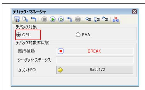
5. FAA プログラムをデバッグするには、FAA が動作許可状態 (FAAEN=1、ENB=1) になっている必要があります。CPU プログラムを FAA の動作を許可するコードまで実行します。main.c を開き、「FAACNT = 0x0001U;」のメイン・エリアをクリックし、ブレークポイント (ソフトウェアブレーク) を設定します。
